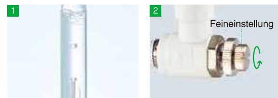
1 Die CO 2 Versorgungsrate lässt sich leicht anhand der vom CO 2 Bubble Counter aufsteigenden Bläschen ablesen. 2 Bei der Feineinstellung der CO 2 Versorgungsrate ziehen Sie die Schraube zunächst an, bevor Sie sie wieder langsam lösen.
